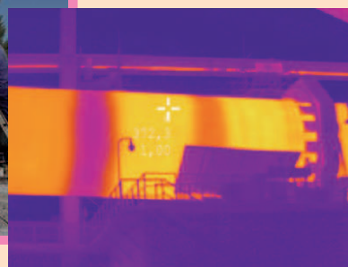
Na plášti je vidieť rozloženie teplôt
