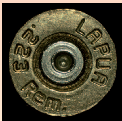
Nájdená nábojnica - stopa po úderníku (v strede)
